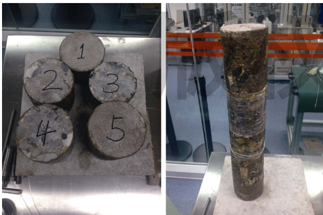
图1 全直径岩心及拼接示意图
