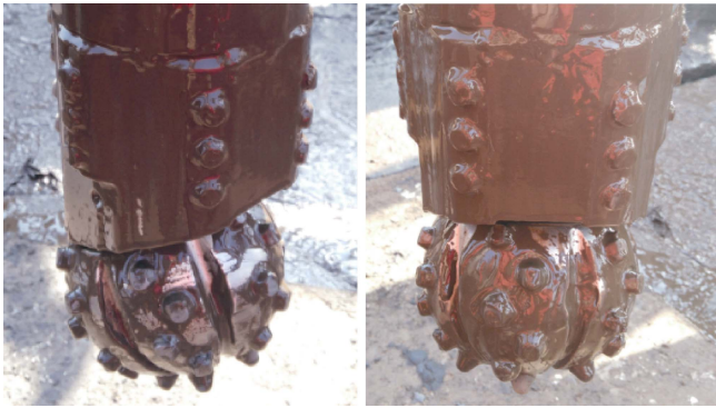
图5 起出井口的单牙轮钻头
